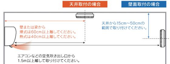
天井・壁面取付共通 ●照明機器などの熱源から50cm程度離すことをおすすめします。上記を守ったうえで、照明器具から 50cm 程度離して下さい。
